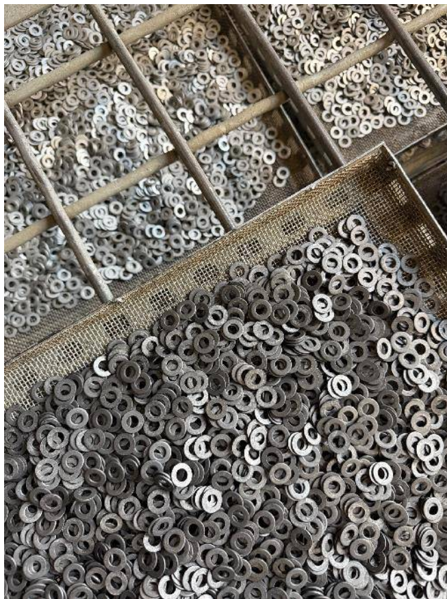
Шайбы, покрытые цинк-ламелью на производстве ООО "АнтикорTex"
