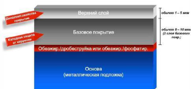
Системы нанесения ламельного покрытия цинка Типичная схема распределения слоев покрытия
